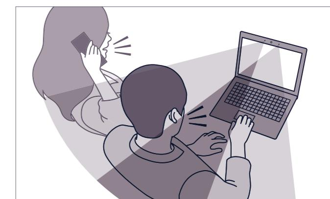
内蔵マイクにビーム状の強い指向性を持たせることで、隣の人の声や環境音、キーボードの打鍵音など、周囲の雑音を低減します。
