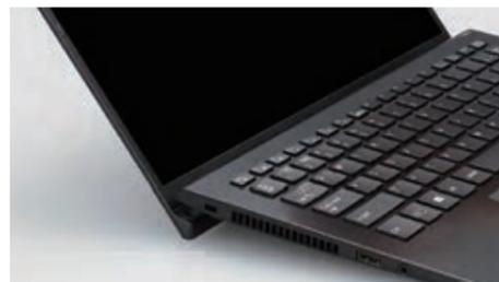
ディスプレイを開くとキーボード奥部が持ち上がり、タイピングしやすい角度がつく「チルトアップヒンジ」機構を採用。
