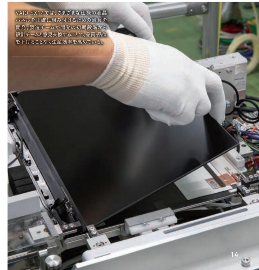
VAIO SX14では、さまざまな仕様の液晶パネルを正確に組み付けるための治具を開発。製造チームが開発の初期段階から設計チームと意見交換することで、品質・品位を下げることなく生産効率を高めている。
