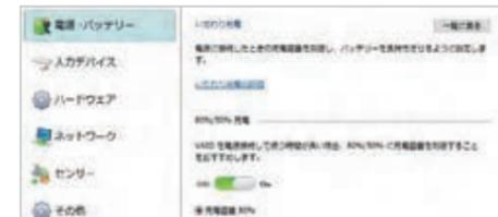
フル充電状態を維持し続けると劣化し、寿命が短くなる内蔵バッテリーを長く使えるようにする「いたわり充電モード」を搭載。
