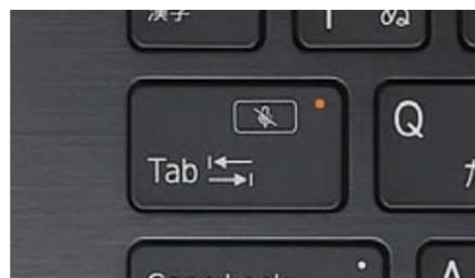
独自のショートカット(Fn+Tabキー)ですべてのマイクをワンタッチでミュート(消音)。動作状況はTabキーのランプで確認可能。
