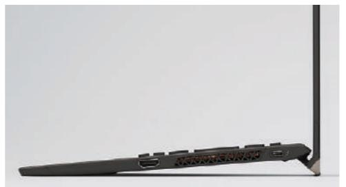
ディスプレイを開くとキーボード奥部が持ち上がり、タイピングしやすい角度がつく「チルトアップヒンジ」機構を採用。
