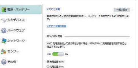
フル充電状態を維持し続けると劣化し、寿命が短くなる内蔵バッテリーを長く使えるように「いたわり充電モード」を搭載。
