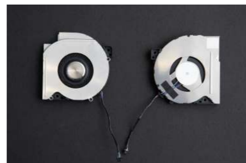
VAIO Zでは高性能CPUから発生する熱をダブルファンで効率的に排出。
