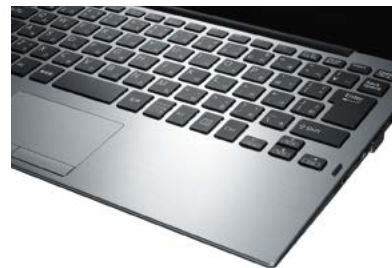
株式会社東陽理化学研究所製、フラットアルミバームレスト(写真はVAIO A12)
