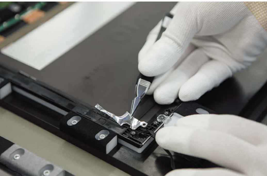
株式会社東陽理化学研究所製、フラットアルミバームレスト(写真はVAIO A12)
