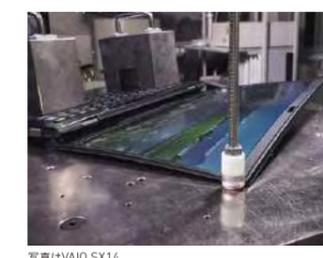
物を挟んだまま閉じる「ペン挟み試験」や、ディスプレイをグッと捻る「液晶180度開きひねり試験」など、他の製品と同じくVAIOの独自試験をクリアしており、さまざまな利用環境で安心して使えます。
