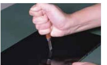
強化ガラスの強度を彫刻刀の先端で強くひっかくという方法で検証。ハードな試験にもかかわらず少しの傷も残りませんでした。
