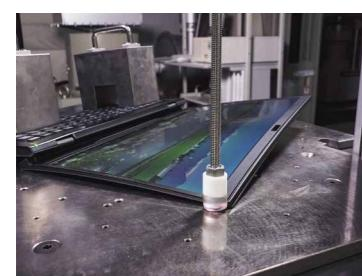
液晶180度開きひねり試験
