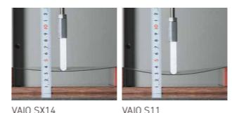
天板は、堅牢かつ軽量のキーパーツとして無数の積層シミュレーションを経て実現した、東レ株式会社製の新UDカーボンを採用。同一荷重時のたわみ比較でも、目視できるレベルでの強度アップを実現しています。
