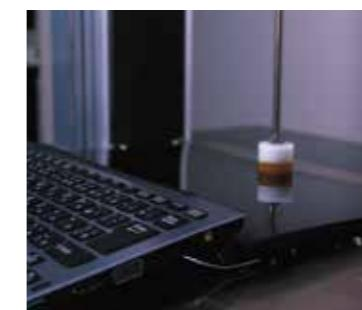
180度までタブレット側を強制的に開く試験を行い、その状態でもヒンジのドッキング機構が壊れないか確認しています。
