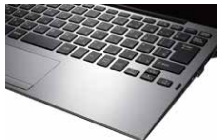
株式会社東陽理化学研究所製、フラットアルミバームレスト(写真はVAIO A12)
