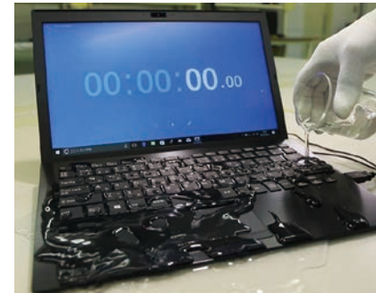
キーボード水かけ試験 (VAIO Pro PJ / PK / PA / PG / PF で実施)
