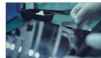
隙間・段差など誤差が出やすい部分は、サイズが細かく設定された「スキマゲージ」で調べ上げます。
