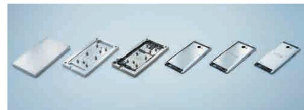
アルミニウムボディの製造工程
