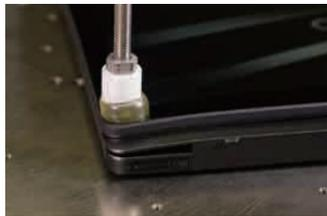
強く押ししても液晶が壊れにくい構造を目指す
