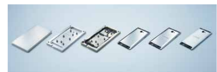
アルミニウムボディの製造工程
